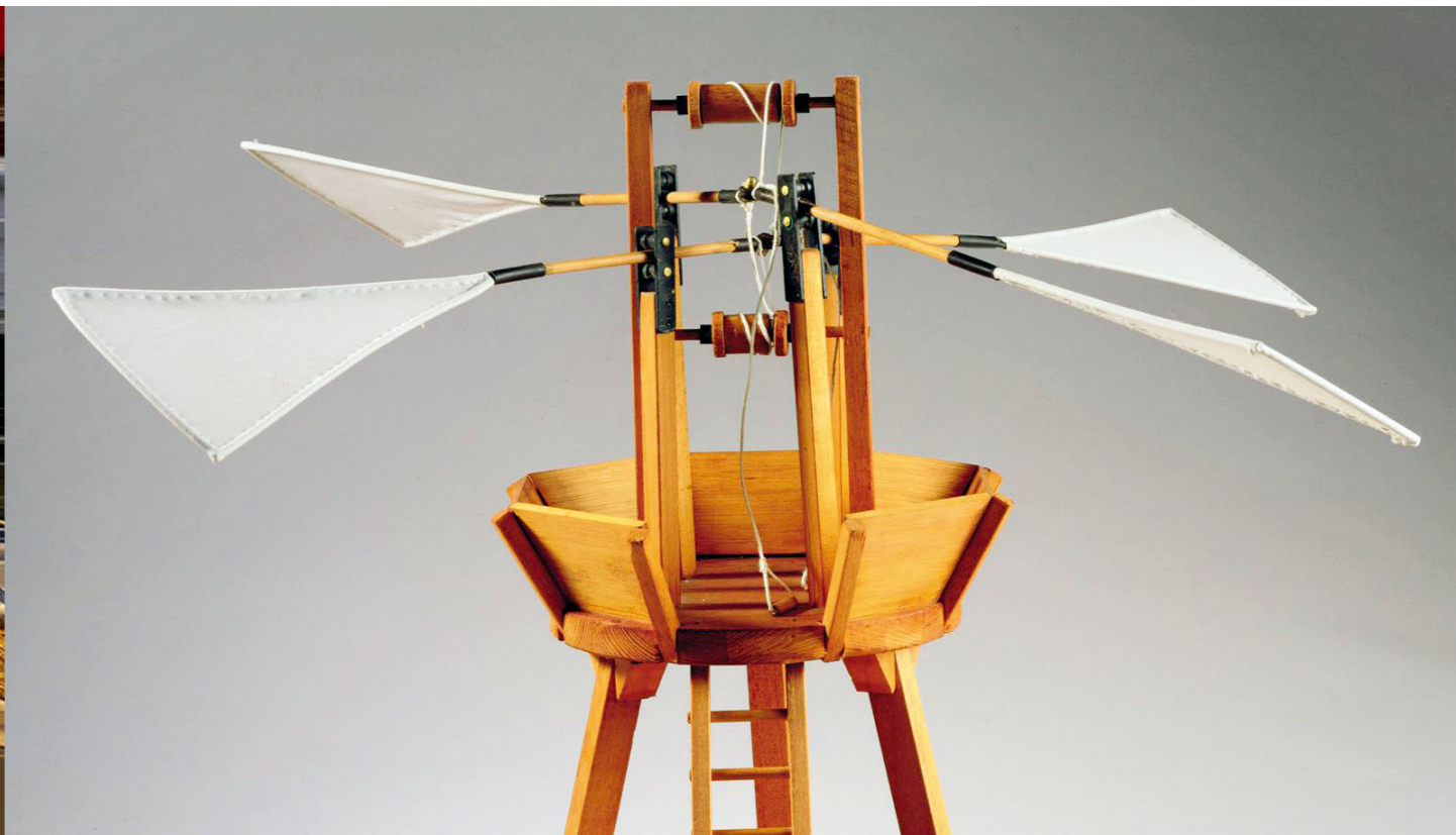
据达·芬奇手稿复原的扑翼驱动装置。
