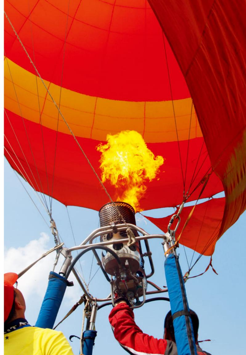
热气球通常使用丙烷或液化气作为燃料，一次热气球飞行在吊篮内标准配置4个重20公斤的气瓶。摄影/本刊记者薛海鹏
