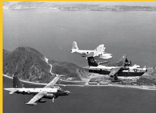
水上飞机 (Seaplane) 泛指利用水面起飞、降落和停泊的飞机，分为船身式（即按水面滑行要求设计的特殊形状的机身）和浮筒式（即把陆上飞机的起落架换成浮筒）两种。第一架水上飞机是由法国工程师亨利法德于1910年3月发明的。第一次正式有水上飞机这个称呼则是1913年英国丘吉尔所提出的。
