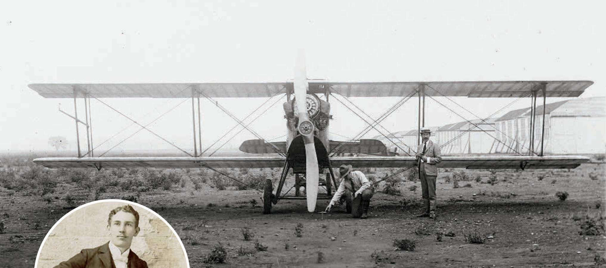
1919年，在装有Moss博士带领团队开发的GE涡轮增压器的Liberty发动机驱动下，一架Lepere双翼飞机成功爬升到30000英尺高空飞行，且推力不减，创造了航空业的历史
