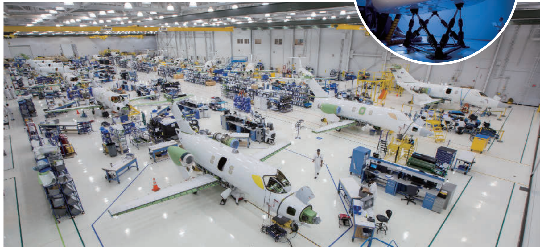
（下图）HondaJet总装车间共有14个可停放HondaJet的工位，也就意味着同时可以有14架飞机在这里完成装配生产
