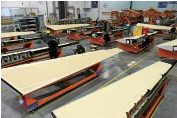
A320 方向舵的舵面采用手工铺层、纸蜂窝加强刚性结构
