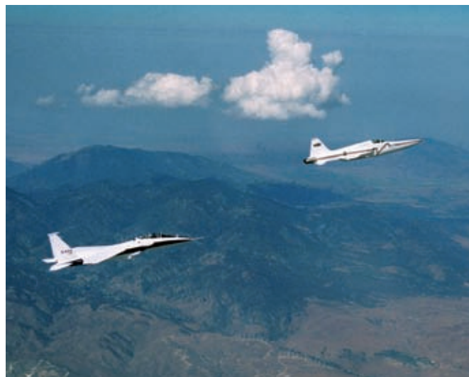
2003年8月，NASA用改装而来的F-15和F-5E进行音爆修型实验。F-15飞进F-5E制造的音爆内部收集数据。Carla Thomas 摄
