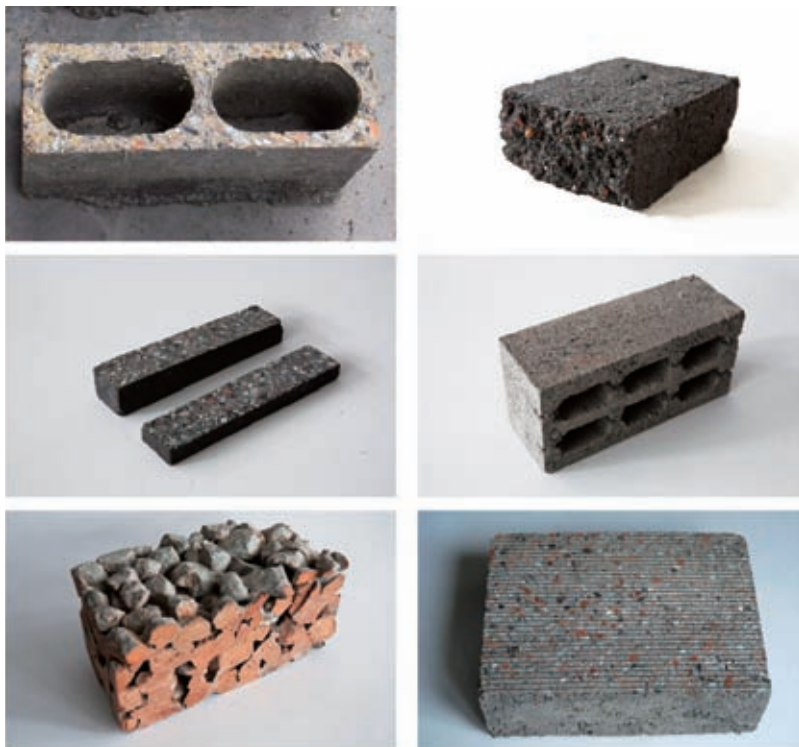
利用汶川大地震废墟材料制成的“再生砖”
