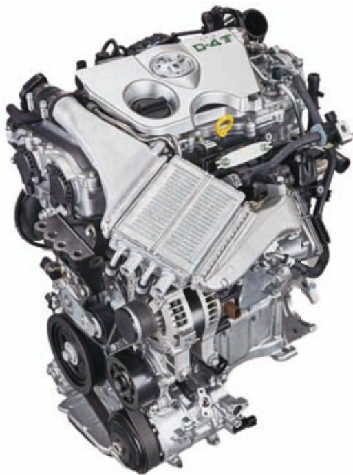
下做功的过程。正因为——比如四缸发动机——是偶数气缸，相同数量的气缸间可以通过“同向冲程”抑制掉震动。不明觉厉？是，这也是先天的一个优势，偶数缸的这种“一阶震动”天然就小。旋转扭矩所产生的震动被称为“二阶震动”，它是由气缸下方的曲轴带动活塞在运转过程中，处在不同行程阶段时产生的。还是四缸发动机，如果发生抖动，差不多就是“二阶震动”引起的。
