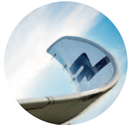
翼梢小翼位于飞机机翼的翼梢，用来改善航空器的操纵特性。
